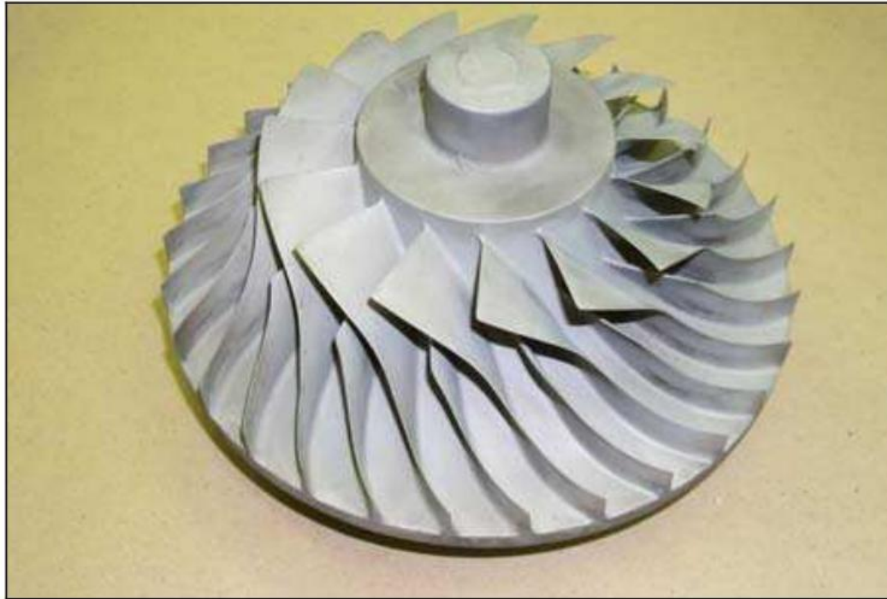
fig. 14 – Compressore e turbina con rivestimento in materiale ceramico
